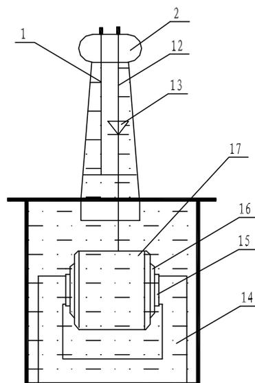
图 2：单台试验变压器内部结构图
