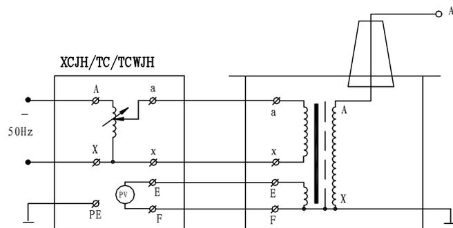
图 3: 单台 YD (JZ) 高压试验变压器原理图
