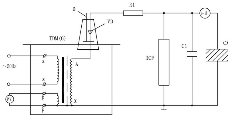
图 7：高压直流泄漏试验接线图
