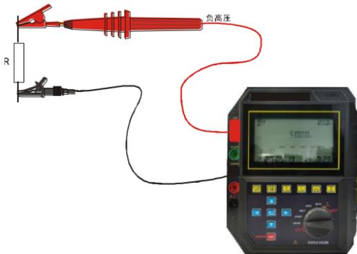
3、测量绝缘电阻时，红色高压棒夹子(LINE)接在被测设备上；黑色测试线夹子 ( EARTH ) 接在被测回路接地端，即被测设备的外壳或者大地。绿色测试线夹子 ( GUARD ) 接在被测试物的屏蔽部分或者其他不参与测量的部分，以消除表面泄漏电流的影响（详见“屏蔽端 GUARD 线的使用方法”相关内容。如下图所示：
